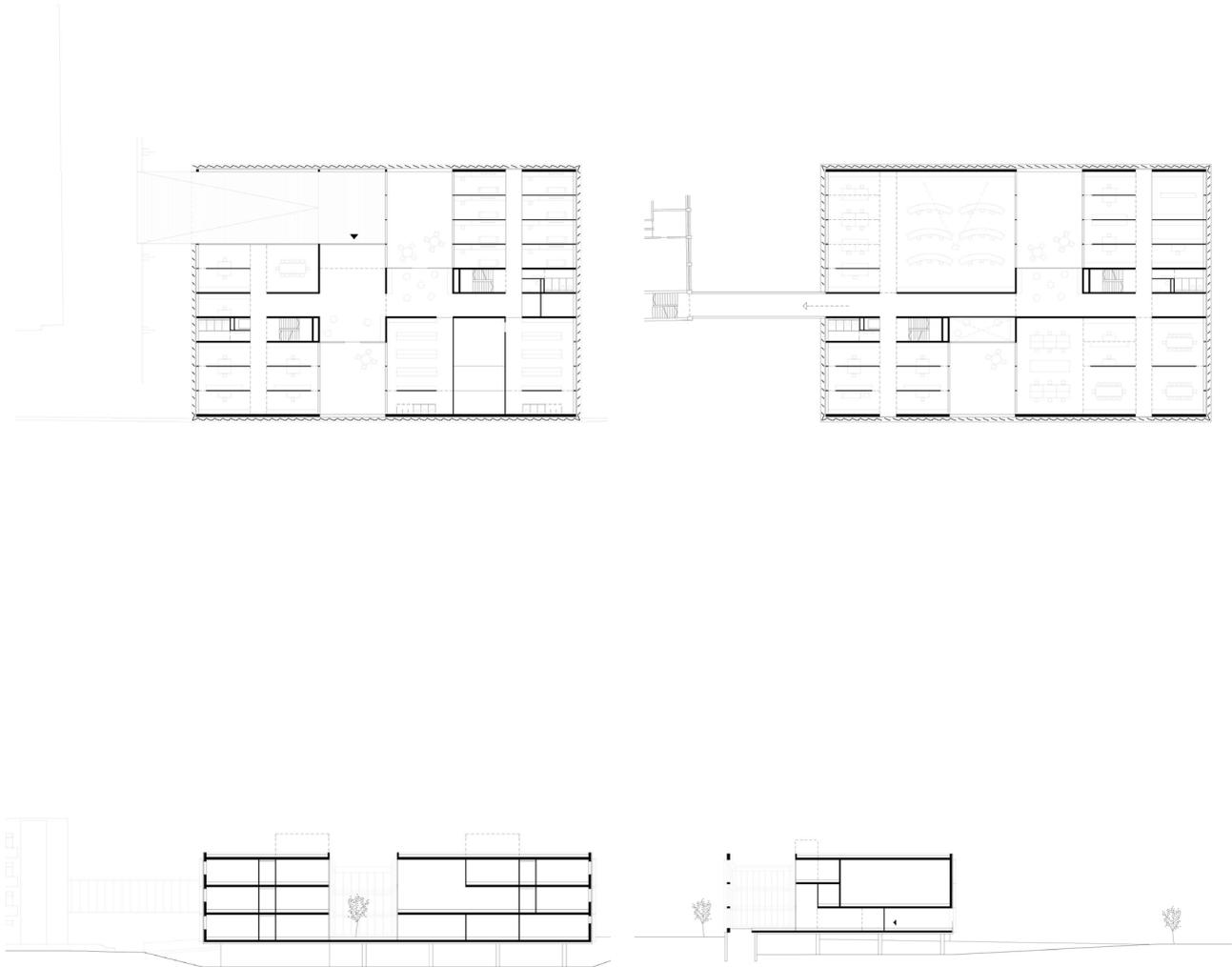
„Ein pragmatischer Grundrissansatz: zwei Haupträume zueinander versetzt, zwei Innenhöfe, eine zentrale Erschließung, eine einzige, klar definierte Eingangssituation und eine Brücke zum Bestand.“
